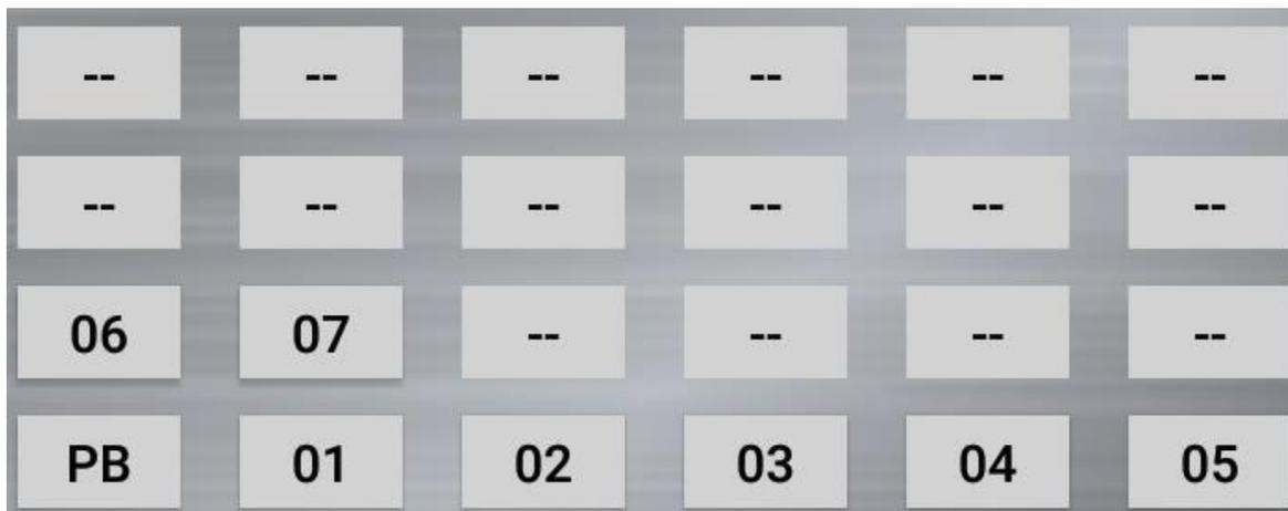
Panel de botones de llamadas activos en función del número de paradas al cual el controlador WENCODOR está configurado. Al presionar un botón este se activará en color amarillo hasta que la cabina llegue a esa estación.
